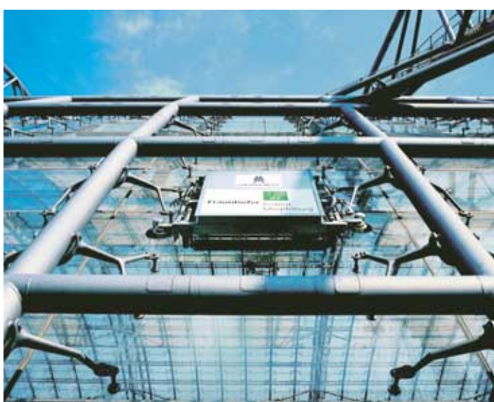
Automatisch: Reinigungsroboter Sirius hält die Glashalle der Neuen Messe zu Leipzig von außen sauber. Foto: Berndt Liebl/Fraunhofer IFF
